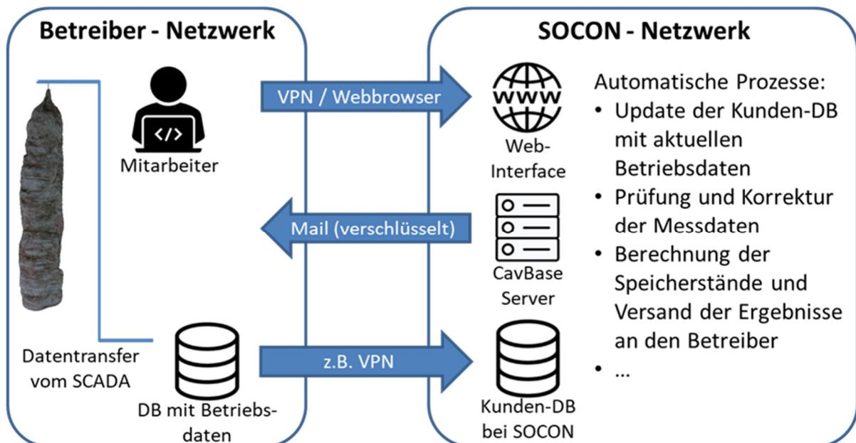
Einbindung des Simulationsprogramms CavBase GasStorage als webbasierter Service (Cloud-Service)
