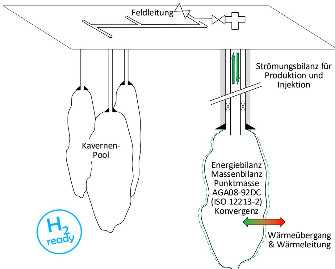
*Berechnungsmodell von CavBase GasStorage für eine einzelne Kaverne sowie für einen parallel betriebenen Kavernen-Pool.*
