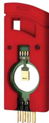
Platine mit Sensor und Auswerteelektronik im Steckchassis
